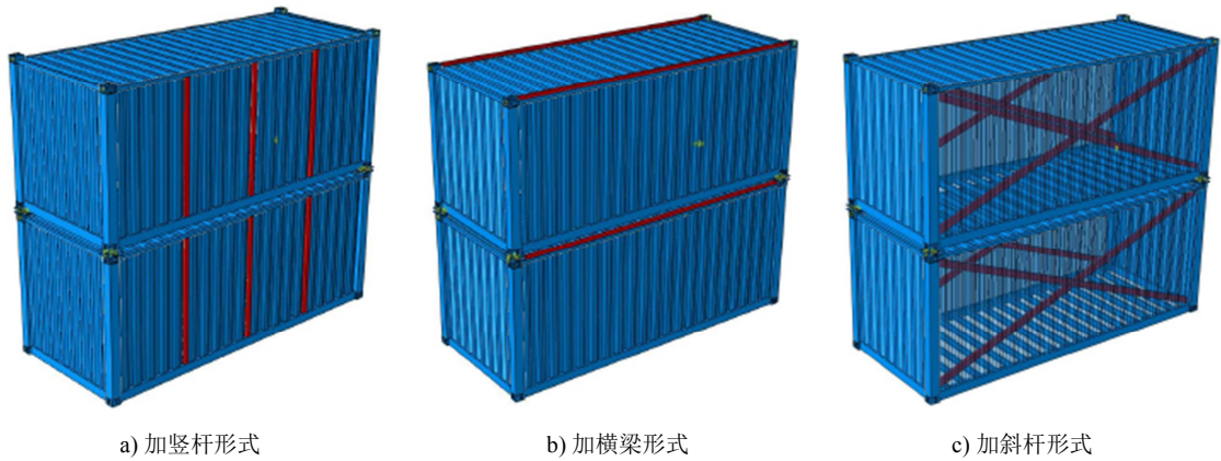
图9 集装箱体骨架形式。
