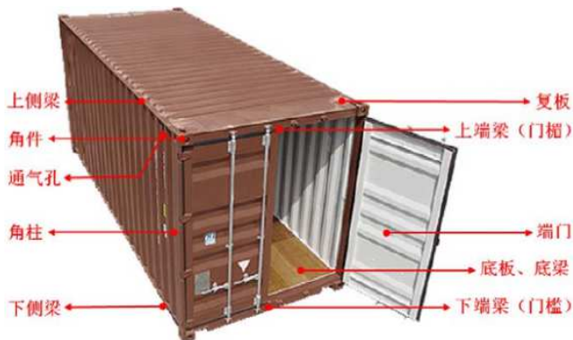
图1 英尺集装箱的组成部件示意图。
