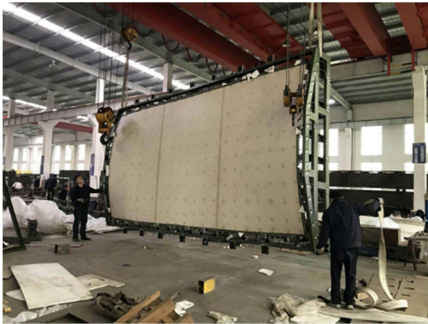
图1 马鞍形雷达罩膜结构。
