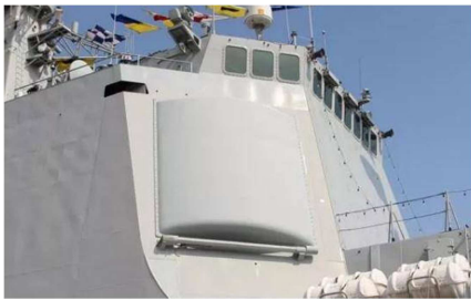
图2 相控阵圆弧形雷达罩膜结构。
