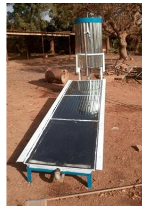
Figure 4. Photo du prototype du chauffe-eau solaire étudié de l'IRSAT.
