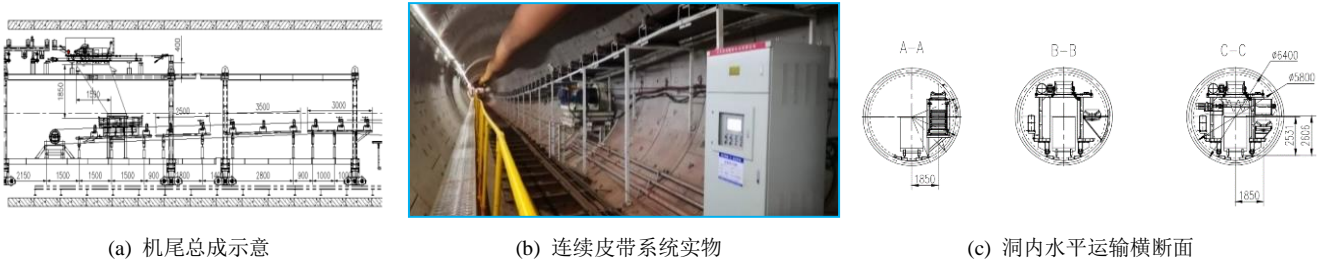
图2 机尾总成示意、水平连续皮带装置实物。
