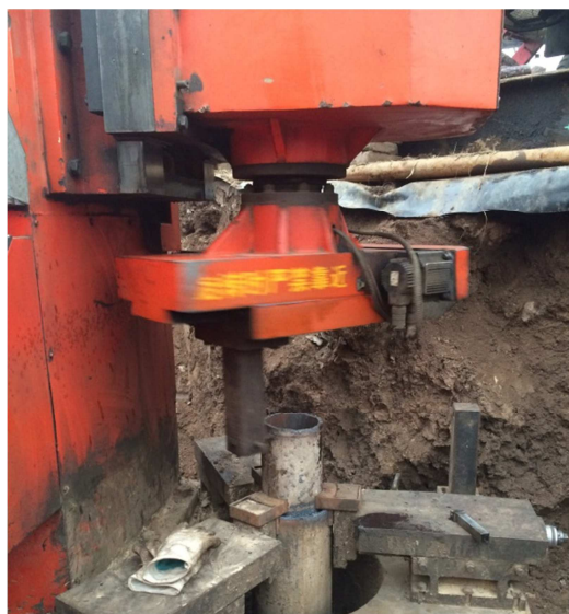
图3 立式车床车扣。
