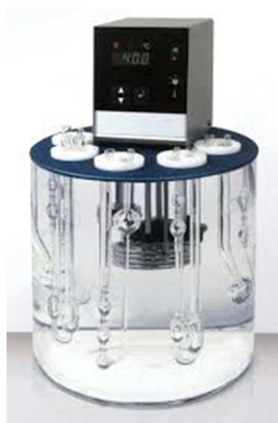
Fig. 2. Viscometer apparatus.
