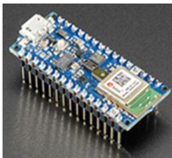
Figure 3. Arduino Nano 33 BLE sense Rev 2.
